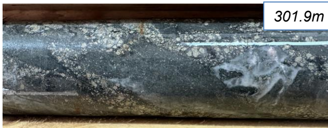
Chlorite-sericite-pyrite-carbonate altered feldspar phyrlic andesite: 0.11 g/t Au 3 ppm Bi 6 ppm Te / 3m (300-303m)
