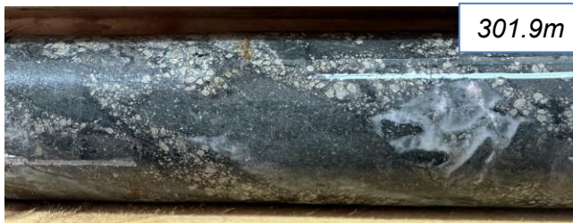
Chlorite-sericite-pyrite-carbonate altered feldspar phyrlic andesite: 0.11 g/t Au 3 ppm Bi 6 ppm Te / 3m (300-303m)
