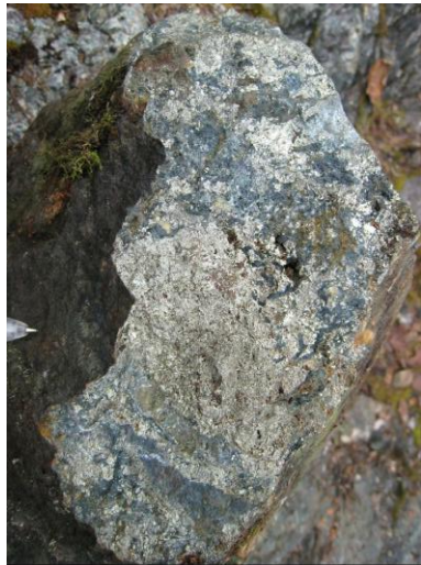
Massive sulfide 5.9 g/t Au 6.1% Cu
