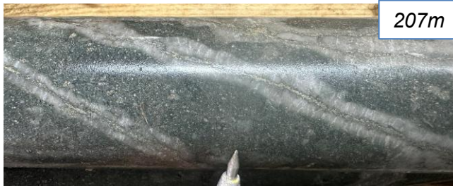
Carbonate-pyrite veins: 0.02 g/t Au 785 ppm Cu / 3m (204-207m)
