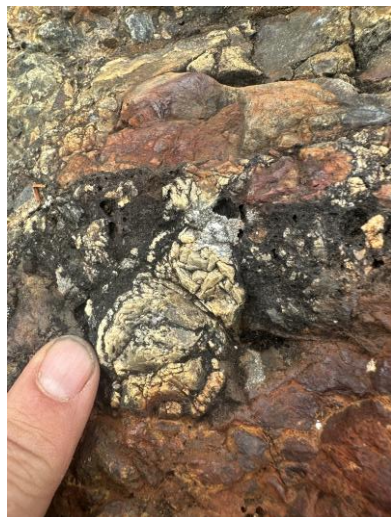
Massive sulfide 5.9 g/t Au 6.1% Cu
